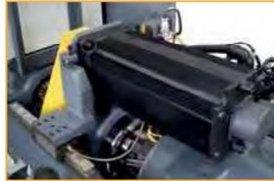
*L'unità di iniezione è supportata dalle guide lineari che forniscono un contributo importante durante le fasi di iniezione.*
