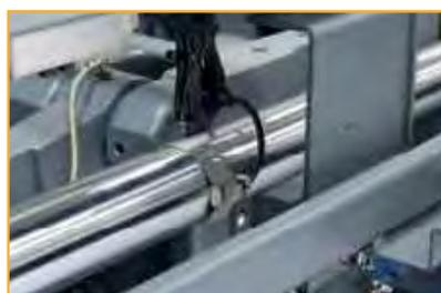
Il sensore di forza montato sulle colonne permette alla macchina di aggiustare continuamente ed in automatico la forza di chiusura adattandola dinamicamente alle caratteristiche dello stampo ed assicurando sempre stabilità.
