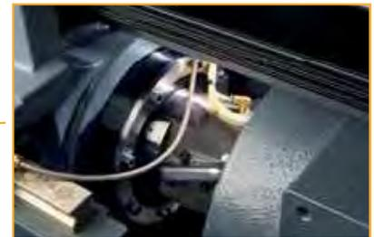
*La ECSXIII utilizza una cella di carico avanzata che controlla accuratamente la pressione di iniezione. Assieme al controllore V70, questa cella di carico migliora e stabilizza lo stampaggio scientifico indipendentemente dallo stampo e senza l'utilizzo di trasduttori interni allo stampo.*
